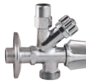
5309 Sarokszelep 1/2" x 3/4" x 3/8", mosógép leágazással, visszacsapó szeleppel, króm
